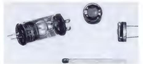
Bild 4. Fotowiderstand  $R_2$  und Lämpchen  $L$  sind in einem lichtundurchlässigen Kolben vereint (Gehäuse aufgeschnitten)
